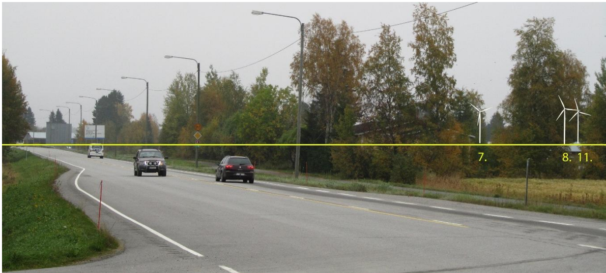
Kuva 51. Rautalankamalli (kuvauspiste 1) valtatieltä 8 Mehtäkyläntien risteyksestä koillisen suuntaan kuvattuna. Etäisyys lähimpään suunniteltuun tuulivoimalaan on noin 5,8 kilometriä.
